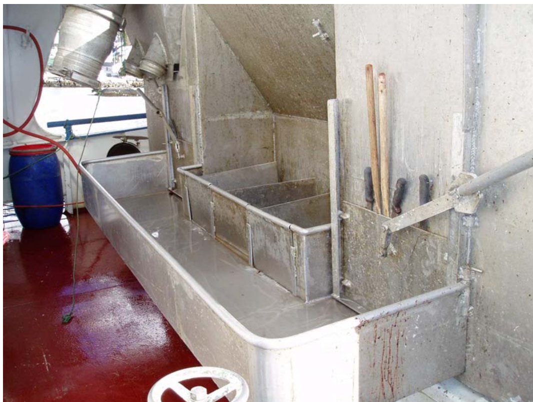
Bilde 2 Fisken tas inn i mottaksbinge på shelterdekk og bløgges før den går ned på hoveddekk
