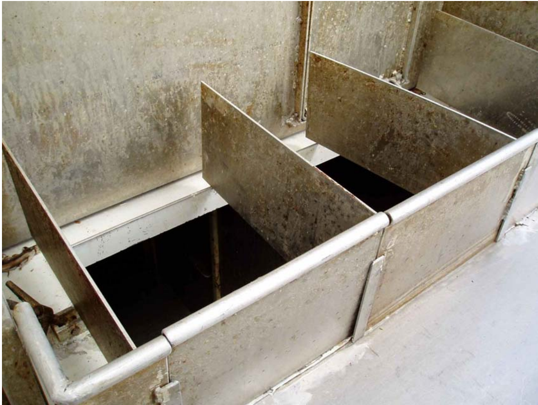
Bilde 3 Opptil tre mann kan stå bakom mottaksbingen og bløgge fisken før sløyting
