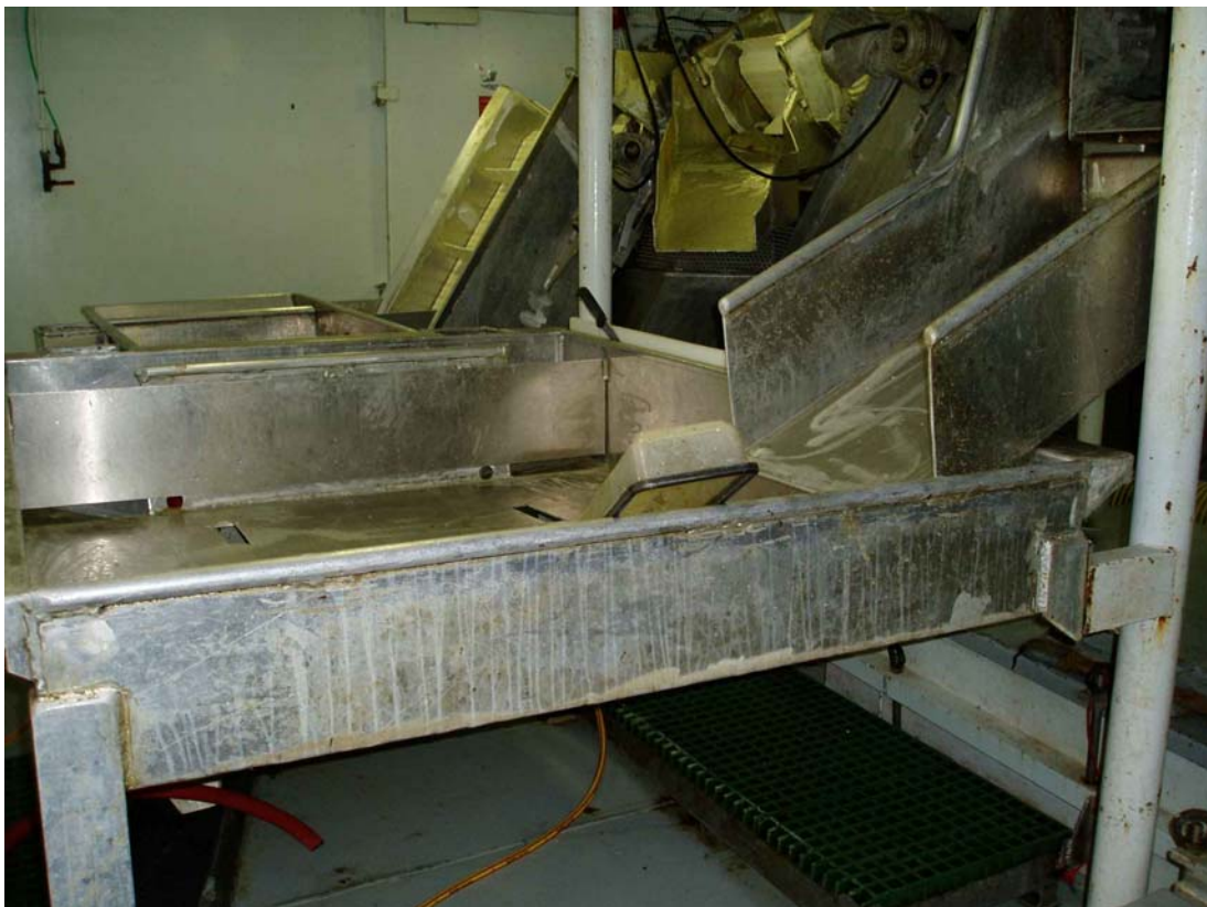
Bilde 4 Bløgget fisk kommer ned i renner fra shelterdekk til sløyebinge på hoveddekk
