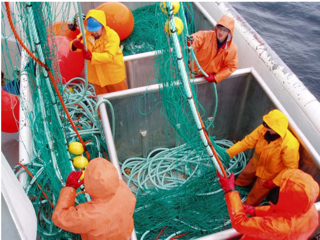
Bilde 12 Snurrevadnota hales og legges i egne binger plassert i en større notbinge
